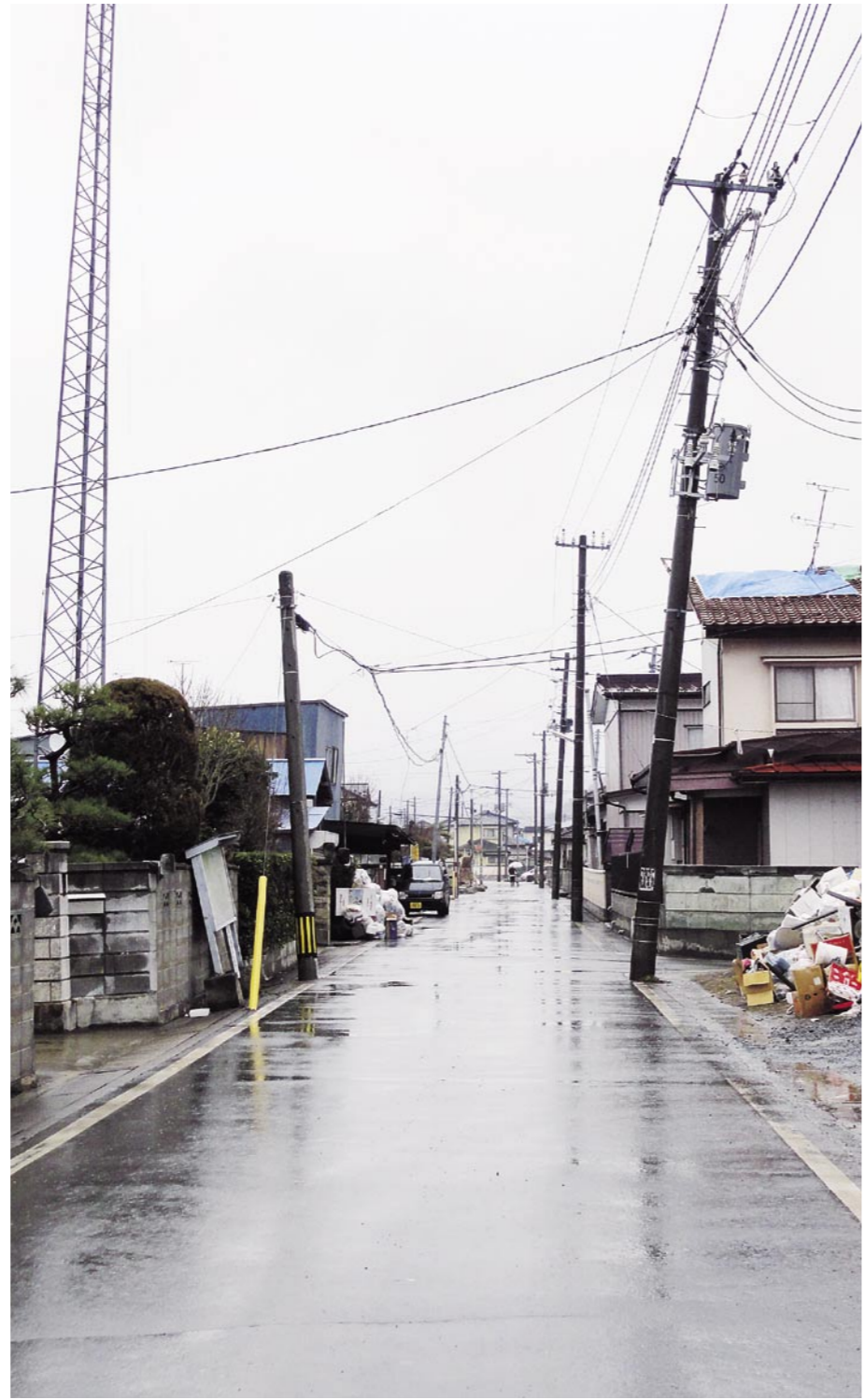
電柱や塀が大きく傾いている。右側手前の住宅も、よく見ると道路側に傾いている
