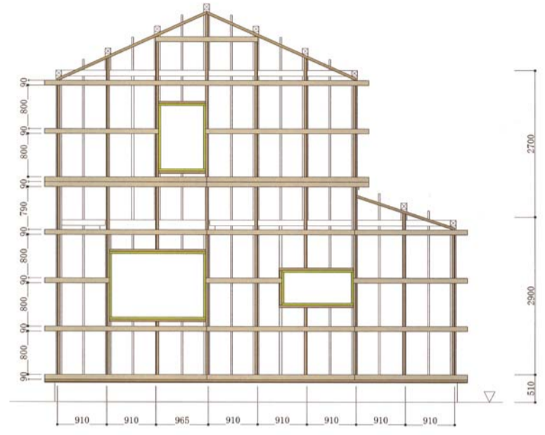
ハシゴ形状パネルを910ピッチで使う工法の割付図
