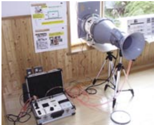
住宅での性能・環境測定としては最もよく知られている気密測定。多くの住宅会社が性能保証や施工精度の向上に役立っている
