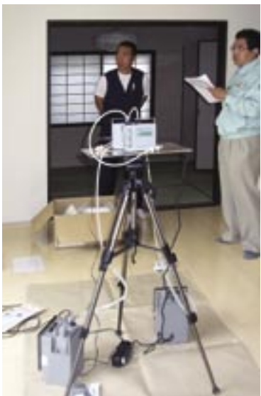
吸引ポンプで室内空気を採取しているところ。この後、高速液体クロマトグラフ法などによって有害化学物質の濃度を分析する
