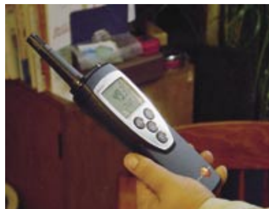
ハンディタイプの温湿度計は表面温度を測るタイプと、特定の空間温度を測るタイプがある。写真は後者のタイプ
