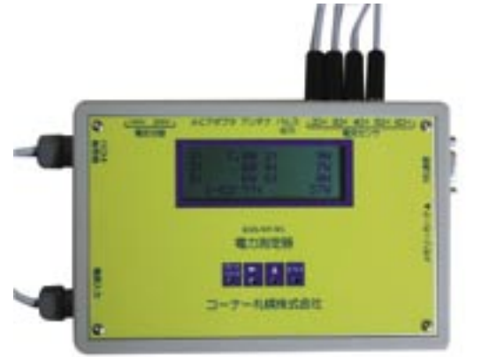
家電製品や電化設備ごとに消費電力量を調べることができのコーナー札幌の電力測定器
