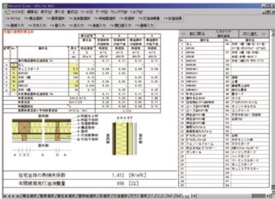
室蘭工業大学・鎌田研究室が開発した住宅の熱損失係数と年間暖房灯油消費量の計算ソフト「QPex」。このソフトを使うところからQ1.0プロジェクトがスタートした
