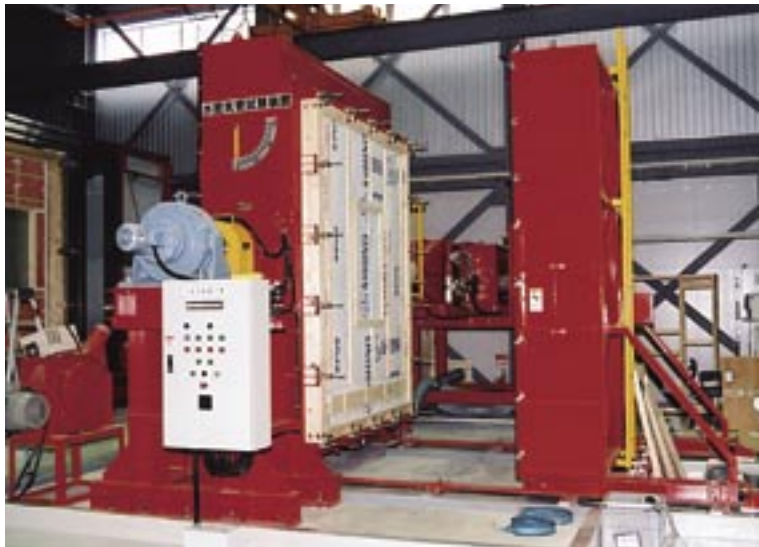
耐火試験装置(上)や水密試験装置(下)など、充実した実験設備で依頼試験や性能評価を始め多様なニーズに対応する
